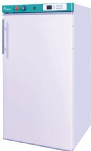
Congelador de 90 Litros de -18/-30°C con control digital de temperatura, sistema de ventilación estático y alarmas sonoras y visuales independientes por fallo de sonda, tensión y puerta abierta.
