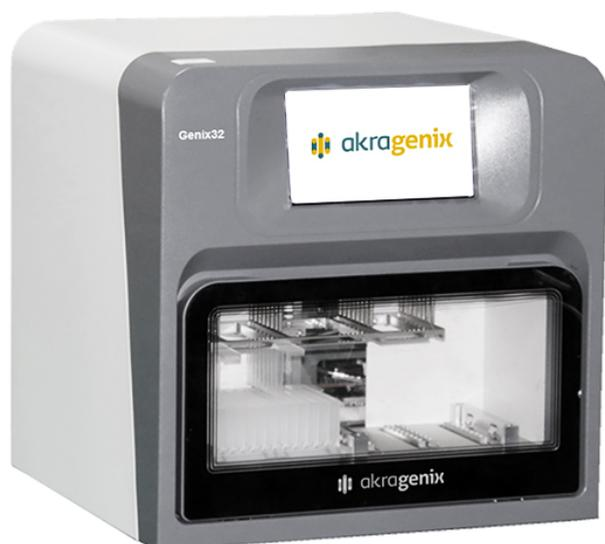
Dispositivo de diagnóstico in vitro para extraer y purificar los ácidos nucleicos de muestras clínicas, por el método de perlas magnéticas. Procesa hasta 32 muestras en un tiempo de entre 9 y 30 minutos. Sistema sencillo y seguro que evita contaminación cruzada y configurable según las necesidades del usuario.
