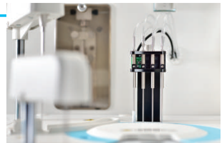
Sistema de autolavado mejorado que garantiza contaminación baja y consumo mínimo de agua.
