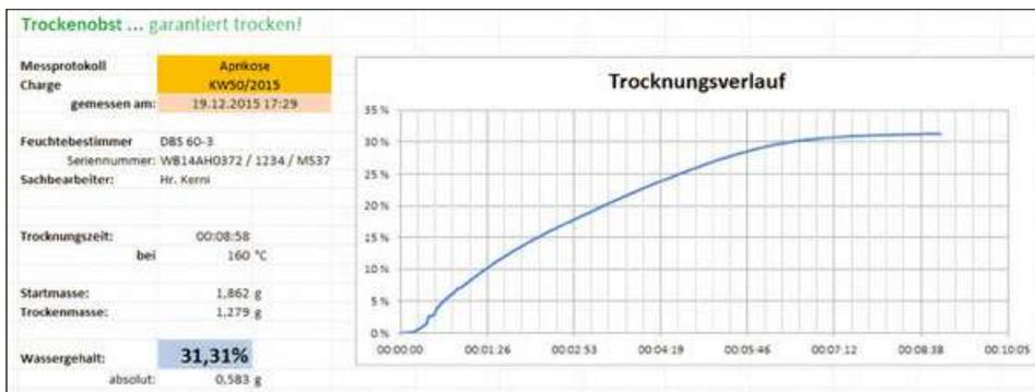
Protocolo de medición con diagrama de progresión del análisis de humedad
